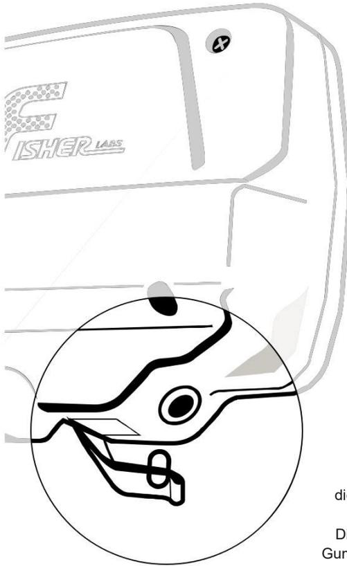
Dieser Detektor verfügt über eine 1/4-Zoll-Kopfhörerbuchse.
