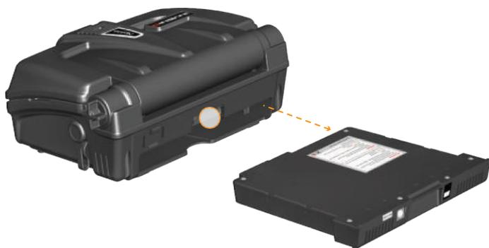
Drücken Sie die Laschen auf jeder Seite der Batterieabdeckung um die Abdeckung, und die Batterie zu entfernen.
