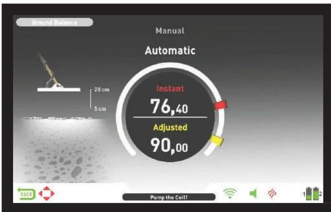
3) Halten Sie die Suchspule parallel zum Boden. Halten Sie den Abzug weiter nach vorne gedrückt und pumpen Sie die Suchspule ab ca. 20 cm auf und ab. (~ 8 ") über dem Boden bis zu 5 cm. (~ 2 ") mit sanften Bewegungen vom Boden abheben und parallel zum Boden halten (dies wird auch durch Animation auf dem Bildschirm angezeigt).
