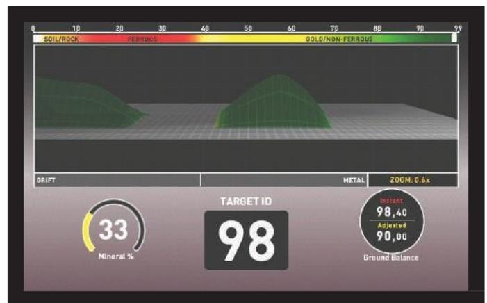
Während der Suche in diesem Bildschirm können Abweichungen in beide Richtungen auf der Drift-Metal-Leiste auftreten. Wenn sich der Balken in DRIFT-Richtung füllt, wird auf dem Oszilloskop nichts angezeigt und das Gerät erzeugt kein Audio. Wenn die Drift dagegen in METAL-Richtung erfolgt, erscheint auf dem Oszilloskop ein flacher, kontinuierlicher Graph, und das Gerät erzeugt eine Audioantwort.
