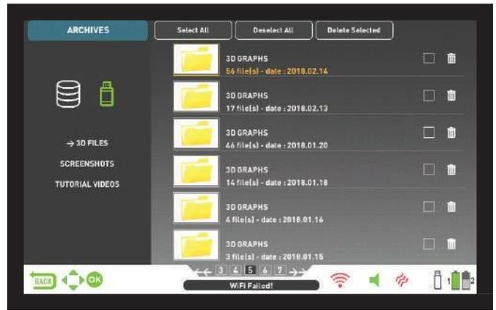
Wenn ein USB-Laufwerk in das Gerät eingesteckt ist, wird das USB-Symbol im Archivbildschirm und in der INFO-Leiste angezeigt. Sobald Sie das Archiv verlassen, wird das USB-Symbol nicht mehr in der INFO-Leiste angezeigt, auch wenn das USB-Laufwerk noch angeschlossen ist. Wenn Sie den Archivbildschirm erneut öffnen, wird das USB-Symbol nach kurzer Zeit wieder angezeigt.
