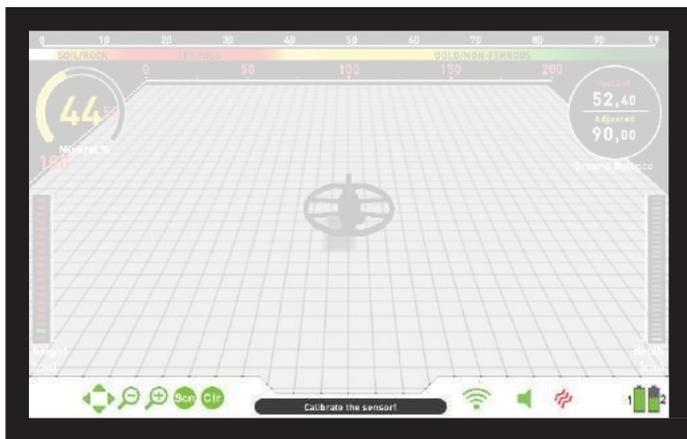
Dies ist die Informationsleiste am unteren Bildschirmrand. Um die Info-Leiste anzuzeigen, drücken Sie einfach die INFO-Taste. Es wird automatisch ausgeblendet oder durch erneutes Drücken der INFO-Taste. Wenn im Nachrichtenbereich eine Warnung angezeigt wird, wird die INFO-Leiste nach einer bestimmten Zeit wieder angezeigt.
