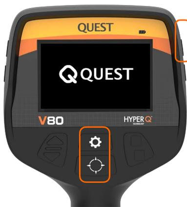
Halten Sie die zwei Tasten auf der Vorderseite gedrückt, während Sie den Detektor mit der Taste an der rechten Kante der Steuereinheit starten.
