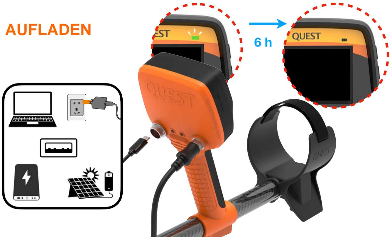
Vor dem ersten Gebrauch wird empfohlen, den Akku 6 Stunden lang vollständig aufzuladen. Verwenden Sie zum Aufladen des Detektors bestenfalls einen hochwertigen Handy-Ladestecker. Verbinden Sie die USB-A-Seite des Ladekabels mit einem Handy-Ladestecker, einer Powerbank oder einem Computer und stecken Sie das kleinere Ende (Typ-C) in die Buchse an der Steuereinheit des Metalldetektors.
