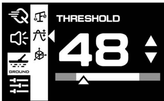
Mit der **Threshold**-Einstellung können Sie die Lautstärke des kontinuierlichen Hintergrundtons ändern, um schwache Signale potenzieller Ziele zu erkennen. Dies ist besonders nützlich, um Objekte zu identifizieren, die andernfalls möglicherweise unbemerkt bleiben würden. Der Threshold-Ton kann auf einer Skala von 0 bis 25 angepasst werden, sodass Sie die Lautstärke dieses Hintergrundtons individuell anpassen können.
