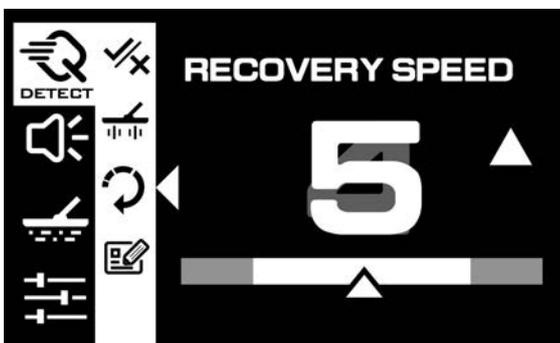
**Reaktionsgeschwindigkeit** oder die sogenannte Reaktivität bestimmt, wie schnell der Detektor nach der Erkennung eines Ziels bereit ist, um ein anderes in der Nähe befindliches Ziel zu erkennen.
