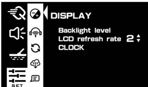
Eine höhere Bildwiederholffrequenz sorgt für eine flüssigere Anzeige, verbraucht jedoch mehr Akkuleistung.
