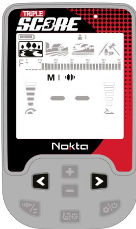
3) Sie können die Empfindlichkeit bei Bedarf mit den Plus- (+) und Minus- (-) Tasten erhöhen. Durch Erhöhen der Empfindlichkeit erhalten Sie eine größere Tiefe. Wenn jedoch die Umgebung oder der Boden übermäßige Geräusche des Detektors verursachen, müssen Sie die Empfindlichkeitseinstellung verringern.
