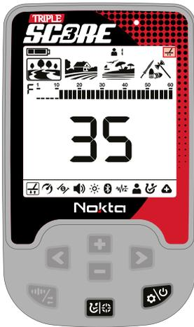
6. Wenn Sie keine Bodenabgleich durchführen können, d.h. wenn kein Piepton erzeugt wird, bedeutet das, dass entweder der Boden zu leitfähig oder nicht mineralisiert ist oder sich ein Objekt direkt unter der Suchspule befindet. Versuchen Sie in diesem Fall, den Bodenabgleich an einer anderen Stelle zu wiederholen.
