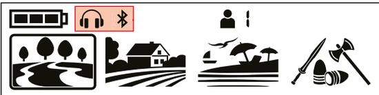
Das Gerät sucht nach den Kopfhörern, mit denen es ursprünglich gekoppelt wurde, und versucht, eine Verbindung zu diesen herzustellen. Dadurch wird verhindert, dass das Gerät eine Verbindung zu anderen Bluetooth®-Geräten herstellt, wenn die Bluetooth®-Einstellung aktiviert ist. Wenn Sie das Gerät mit anderen Bluetooth®-Kopfhörern koppeln möchten (außer denen, mit denen es ursprünglich gekoppelt wurde), müssen Sie diese aus dem Speicher löschen.
