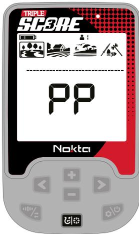
Im Pinpoint-Modus unterscheidet das Gerät keine Metalle und stellt keine Leitwerte bereit.
