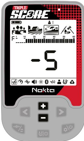
Der Nullwert (0) des Bodenabgleichs stellt den stabilsten Wert dar. Eine Verringerung der Stabilitätsstufe in Richtung -5 kann die vom Strandsand verursachten Geräusche verstärken und die Wahrscheinlichkeit erhöhen, schwach leitfähige Metalle wie Gold zu erkennen, die einen Leitwert von 11 ergeben.
