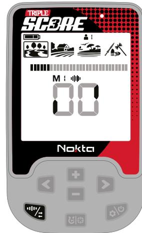
3. Wenn der Vorgang abgeschlossen ist, wird der ausgewählte Frequenzkanal angezeigt und ein Bestätigungston ertönt.
