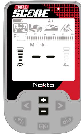
4. Wenn das Gerät beim Erhöhen der Empfindlichkeitseinstellung Geräusche empfängt, können Sie die Geräuscherdrückung aktivieren, indem Sie lange auf die Taste „Frequenz- und Geräuscherdrückung“ drücken, bevor Sie die Empfindlichkeitseinstellung verringern.
