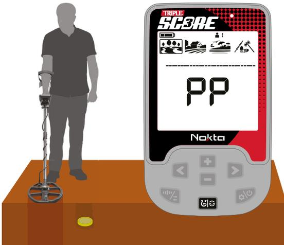
2. Halten Sie die Taste gedrückt und bringen Sie die Suchspule langsam und parallel zum Boden näher an das Ziel heran.
