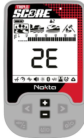
Das ausgewählte Benutzerprofil wird erst aktiv, wenn Sie die Benutzerprofileinstellung verlassen.
