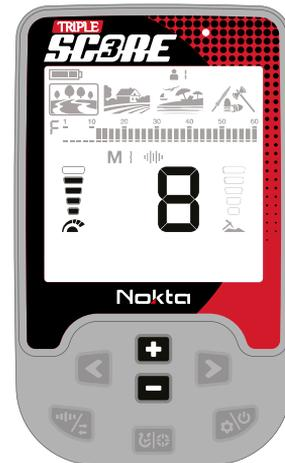
Die Empfindlichkeitsanzeige befindet sich links von der Leitwert-Anzeige. Die Anzeige besteht aus 5 Balken. Jeder Balken repräsentiert 2 Empfindlichkeitsstufen des DOUBLE SCORE und 1 Empfindlichkeitsstufe des SCORE.
