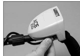
Hinweis: Die Armmanschette kann angepasst werden, indem die sich darunter befindende Schraube entfernt und in ein anderes Loch geschraubt wird.
