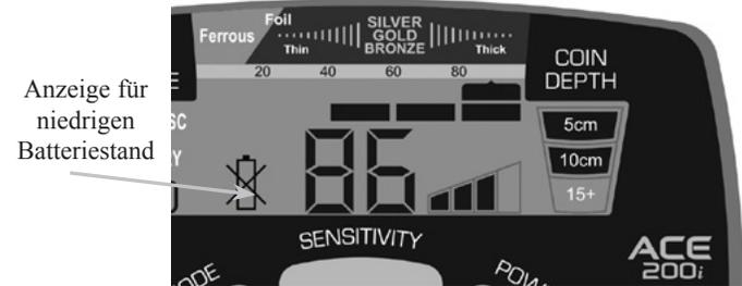
Ein niedriger Batteriestand des Detektors wird durch die Anzeige für niedrigen Batteriestand angezeigt. Der Detektor zeigt die volle Leistung, aber die Batterien sollten nach Auftauchen dieser Anzeige bald ersetzt werden. NiMH-Akkus können verwendet werden, ihre Nutzungsdauer pro Ladung ist jedoch eventuell kürzer. Je nach Batterietyp und -qualität können Sie mit 20 bis 40 Betriebsstunden rechnen.
