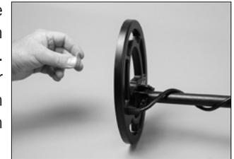
Nachdem Sie festgestellt haben, unter welcher Ziel-ID wie die Testziele bei den Prüfversuchen registriert werden, testen Sie die Objekte im Boden. Vergraben Sie die Zielobjekte in definierten Tiefen, um ein „Testfeld“ zu erstellen. Beachten Sie, wie die verschiedenen Ziele erfasst werden, je nachdem, ob sie flach oder unterschiedlich angewinkelt im Boden liegen.
