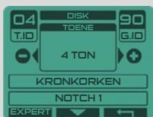
Drücken Sie **MENU** > **DISK** > **EXPERT**. Wählen Sie **2 Ton - 3 Ton - 4 Ton - 5 Ton aus**.
