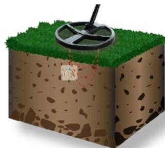
Positionieren Sie die Spule knapp über dem Boden und neben dem Zielobjekt. Drücken Sie
