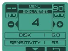
Mit der Signalverstärkung lässt sich die Lautstärke tief liegender Targets verstärken. Das vermittelt den Eindruck einer größeren Leistung, bietet aber keine zusätzliche Tiefenreichweite, denn diese Einstellung wirkt sich nur auf die Klangkurve (den dynamischen Tonbereich) aus. Eine geringere Signalverstärkung vermittelt eine gute Tiefenwahrnehmung.
