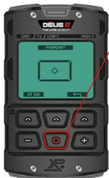
Gehen Sie zum PINPOINT-Bildschirm und aktualisieren Sie durch einen kurzen Tastendruck den Schwellenwert (Threshold, manuelle erneute Abstimmung).
