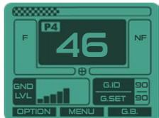
Der DEUS II zeigt tief liegende Targets dank seiner Multifrequenz-Verarbeitung, die einen Großteil der störenden Bodeneinflüsse beseitigt, präziser an.
