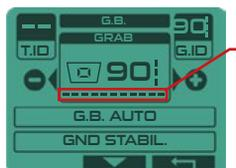
Grad der Mineralisierung. Je höher dieser Wert, umso stärker ist der Boden mineralisiert. Die Spule mehrmals über dem Boden pumpen um den Boden präziser einzustellen.
