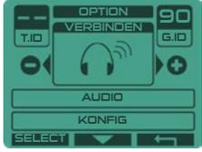
**AUTOMATISCH:** Ist kein drahtloser Kopfhörer verbunden, wählen Sie beim Starten der Fernbedienung das Symbol des drahtlosen Kopfhörers aus. Dann fordert Sie die Fernbedienung zum Verbinden durch zweisekündiges Drücken der Taste **⊖** am Kopfhörermodul auf.
