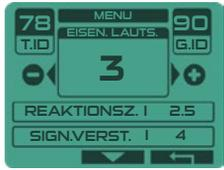
Einstellung der Lautstärke des tiefen Tons, der einen niedrigeren Wert hat als die Unterscheidungseinstellung (Disk) und normalerweise Eisen bedeutet.
