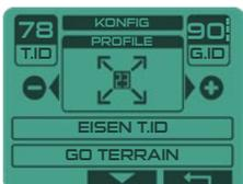
Vollbildanzeige der Ziel-ID, zu finden unter OPTION > KONFIG > PROFILE, oder direkt über die Verknüpfungsoption auf dem Hauptbildschirm: Drücken Sie die beiden Tasten gleichzeitig
