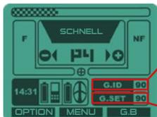
Anzeige der Bodenmineralisierung (ständige Messung zur Orientierung).
