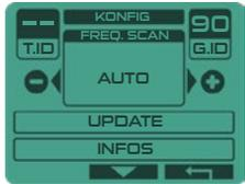
Diese Funktion aktiviert einen automatischen Suchlauf der Detektionsfrequenzen und zeigt bei jedem Programmwechsel oder bei jedem Frequenzwechsel im Programm DEUS MONO einen sauberen Kanal mit möglichst wenigen Störungen an. Der Frequenzsuchlauf des **DEUS II** ist zwar besonders schnell, allerdings verzögert er die Navigation beim Programmwechsel um 2 Sekunden.
