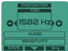
Verstellen Sie den tiefen/hohen Ton im PULSE-Modus zwischen 100 und 1582 Hz.
