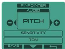
**Audio PITCH:** Der Ton ändert seine Höhe und seine Lautstärke; dies ist die Standardeinstellung, mit der Zielobjekte am schnellsten geortet werden können.
