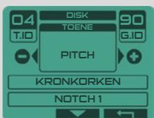
Der Pitch-Modus berücksichtigt die Leitfähigkeit des Zielobjekts nicht: Die Stärke des Signals erzeugt einen Ton, der sich sowohl hinsichtlich der Lautstärke als auch hinsichtlich der Höhe (Frequenz) ändert. Das bedeutet, dass ein entfernteres oder kleineres Zielobjekt einen leisen, tiefen Ton hervorruft, während ein näherer Gegenstand einen lauten, hohen Ton hervorruft. Umgekehrt gilt unter der Discr-Schwelle: Je näher das Target an der Spule liegt, desto tiefer klingt es.
