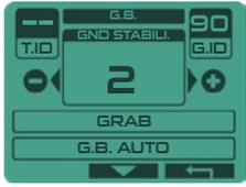
Diesen Wert kann man von 1 bis 3 einstellen. Diese Funktion wird verwendet, um das Maß an Instabilität/Feedback des Bodens festzulegen, das man dulden möchte.
