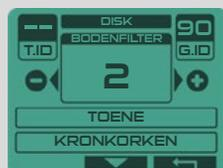
Manche großen Eisengegenstände oder Gegenstände mit ungewöhnlichen Formen sind häufig schwerer zu unterscheiden. Eisengegenstände erzeugen häufig hörbare Reste gebrochener oder unbeständiger Signale (Knattern, Prasseln). Durch Anhebung des Bodenfilters wird das von Eisengegenständen verursachte Knattern herausgefiltert.
