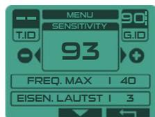
Damit stellt man die Empfindlichkeit des Geräts von 0 bis 99 ein. Die am häufigsten verwendeten Empfindlichkeitseinstellungen liegen zwischen 70 und 90. Senken Sie die Einstellung in Gebieten mit verseuchten Böden oder in der Nähe von Stromleitungen, Zäunen, Richtfunkanlagen etc.
