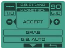
Bei der Suche in magnetischem Boden wie etwa schwarzem Sand können tief liegende Ziele verschleiert werden, weil ihre Werte denen des Bodens ähneln. In der Einstellung für magnetischen Untergrund kann man mittlere Töne akzeptieren, die vom Boden, von Ferrit, von Meteoriten sowie von entfernten Targets stammen und die gewöhnlich überdeckt werden.
