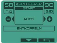
**Auto:** Die mit der Fernbedienung gekoppelten kabellosen Kopfhörer werden automatisch ein- und ausgeschaltet.
