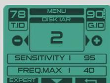
Die Programme **8 GOLD FELD** und **9 RELIKTE** verwenden eine andere Unterscheidungsmethode namens **IAR** (Iron Amplitude Rejection). Dadurch lassen sich eisenhaltige Gegenstände entsprechend ihrer Entfernung von der Spule ausschließen.
