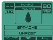
Bei tiefen Tauchgängen kann der Wasserdruck die Tasten der Fernbedienung zusammendrücken. Aktivieren Sie diesen Modus, sobald Sie eine Tiefe von 8 bis 10 Metern erreichen, um das Tastenfeld zu sperren. Das bewirkt, dass das Berühren einer Taste in der Tiefe das Programm nicht unterbricht. Um diesen Modus zu deaktivieren, drücken Sie nacheinander die linke Taste, die mittlere Taste und dann die rechte Taste.
