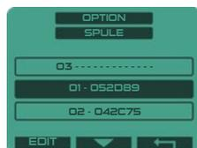
Um die LED der Spule und den drahtlosen Kopfhörer während des Gebrauchs abzuschalten: Wählen Sie unter OPTION > SPULE VERBINDEN wie nebenstehend die gewünschte Spule und drücken Sie vier Sekunden lang die Taste . Im abgeschalteten Zustand wird dieser Modus deaktiviert, die LED kehrt in den Normalbetrieb zurück.
