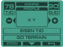
Die Signatur des Zielobjekts wird in Form eines Oszilloskops angezeigt. Der XY-Bildschirm bietet zusätzliche visuelle Unterstützung und kann die Erkennung schwieriger Targets verbessern. Ein Beispiel: Die Erkennung von Targets, die keine präzise Signatur besitzen (manche eisenhaltige Objekte, Dosen etc.).
