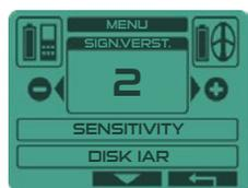
Wenn Sie die Signalverstärkung erhöhen, beeinflussen Sie die Tonkurve und verstärken tiefe Ziele, aber das Gerät wird dadurch auch unruhiger. **Es ist eine wichtige Einstellung Ihres XTREM HUNTERS, um die Reaktion auf den Boden zu kontrollieren, also passen Sie sie an Ihre örtlichen Bedingungen und Erfahrungen an.**
