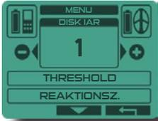
Die IAR-Diskriminierungsmethode (Iron Amplitude Rejection) ermöglicht es, eisenhaltige Gegenstände in Abhängigkeit von ihrem Abstand zu den Spulen auszusondern.
