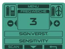
Führen Sie zu Beginn Ihrer Suche immer eine automatische Rauschunterdrückung durch **SCAN** um den stabilsten Kanal in Bezug auf elektromagnetische Störungen (EMI) zu finden.
