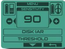
Damit stellt man die Empfindlichkeit des Geräts von 0 bis 99 ein. Die am häufigsten verwendeten Empfindlichkeitseinstellungen liegen zwischen 70 und 90. Senken Sie die Einstellung in Gebieten mit verseuchten Böden oder in der Nähe von Stromleitungen, Zäunen, Richtfunkanlagen etc.
