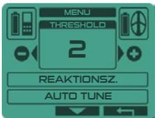
Mit dieser Funktion wird die Amplitude der Hintergrundgeräuschschwelle (HUM) eingestellt. Der Schwellenwert kann erhöht werden, um schwache Geräuschvariationen zu maskieren, und kann als eine Art Empfindlichkeit wirken, indem das Rauschen im Schwellenwertbrummen übertönt wird.
